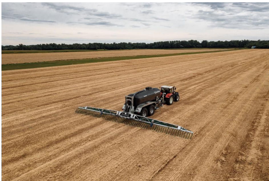
Namensko vozilo za razvoz gnojevke in vnos v tla
